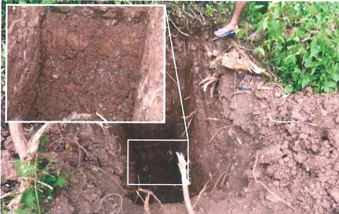
Figura 10. Pozos recientemente cavados en la base del deslizamiento, mostrando surgencias de agua.
