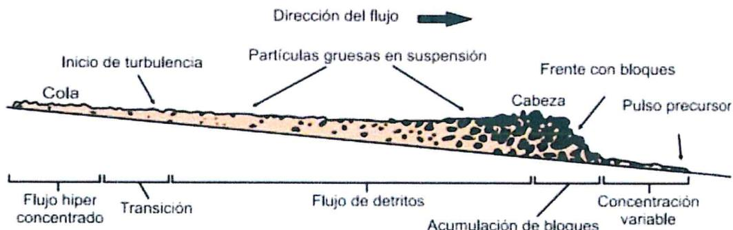
Figura 14. Corte esquemático típico de un flujo de detritos. Frente con bloques de un pulso del flujo de detritos (diagrama de Pierson, 1986, en RMA 2007).
