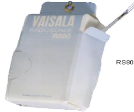
Proporciona el perfil en altura de temperatura, humedad, presión y el viento
